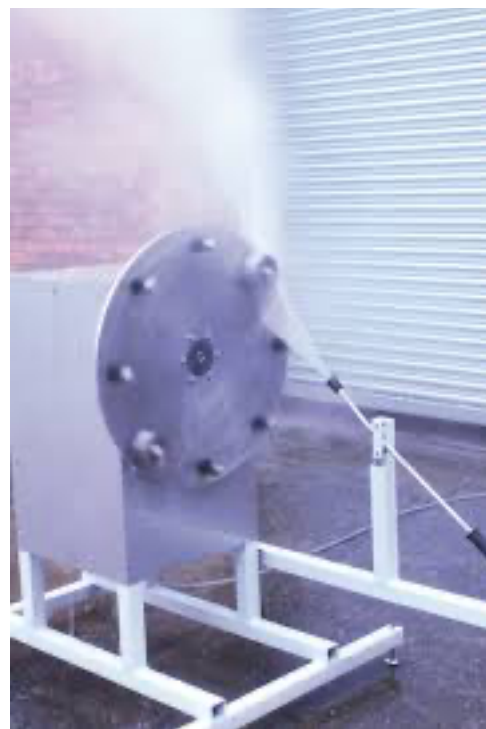
Ciśnienie wody przy sptukiwaniu na stanowisku do prób 110Bar
