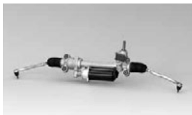
Elektrycznie wspomagany napęd kierownicy ze śrubą toczną kulową (Kat. nr E4102)
